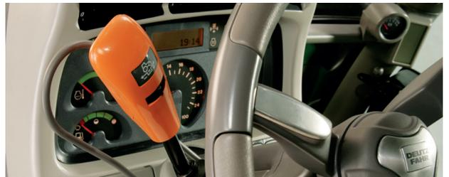
Powershuttle avec SenseClutch : 5 niveaux de réactivité, modifiables au travail.
