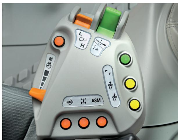
Accoudoir multifonction de série avec commande du relevage arrièresimplifiée.
