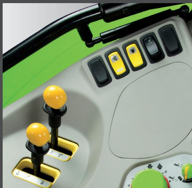
Levier de sélection du régime PDF avec activation et désactivation par le biais de pratiques commandes électrohydrauliques.
