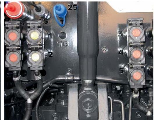
Clairement numérotés : les raccords hydrauliques à l'arrière.
