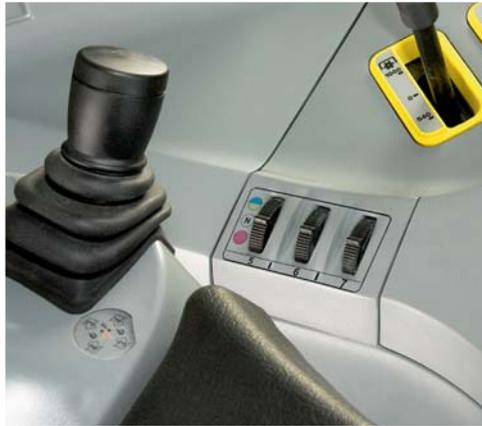
Jusqu'à sept distributeurs auxiliaires peuvent être commandés.
