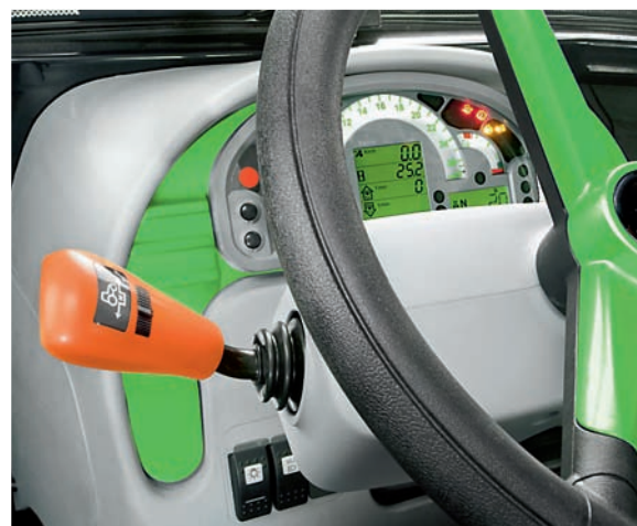
L'inverseur hydraulique est réglable sur cinq niveaux et facilite considérablement les manoeuvres.
