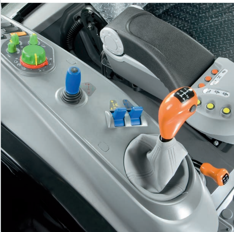
La commande de l'embrayage s'effectue par un bouton situé dans le levier de vitesses.
