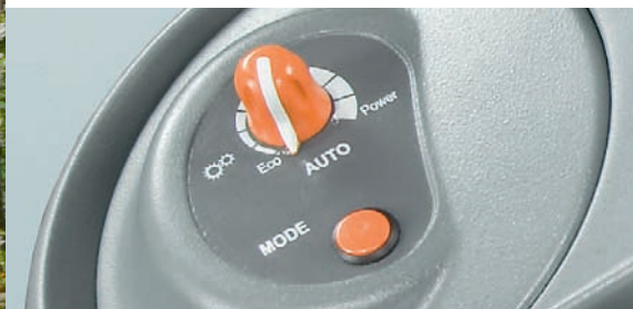
Réglages de la transmission à variation continue.
