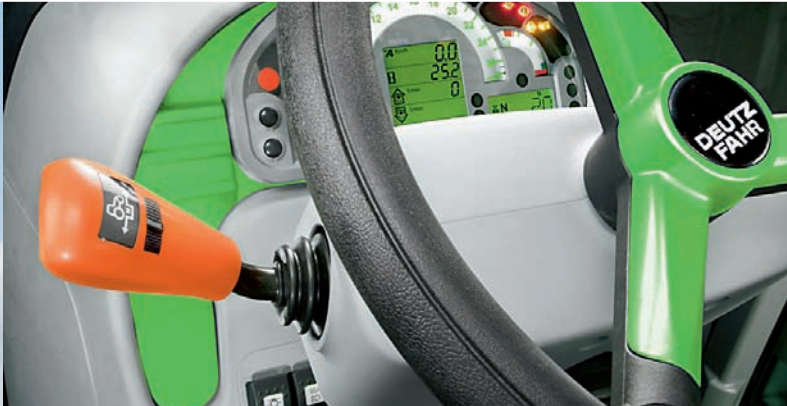
Commande de l'inverseur avec molette de réglage de la sensibilité.
