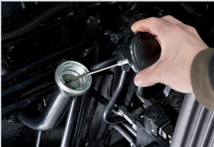
Tous les composants et les groupes principaux sont facilement accessibles pour les opérations d'entretien courant qui ne nécessitent aucun outil. Il est possible de contrôler l'huile moteur sans devoir ouvrir le capot et de vérifier le niveau d'huile de transmission à travers l'indicateur transparent qui se trouve sur le pont arrière.
