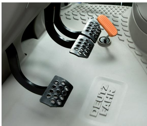
Le dispositif « Power Brake » permet à l'opérateur d'actionner les pédales de frein avec un effort minimal. Les freins réagissent rapidement et en douceur, même lorsque le moteur est éteint.
