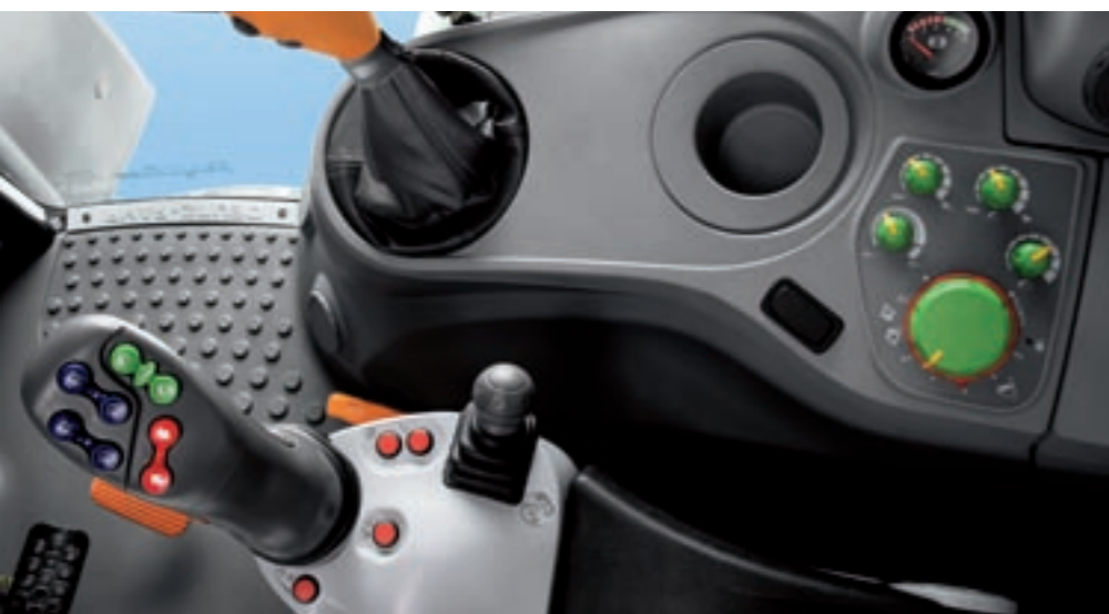
L'accoudoir PowerComS est unique dans cette classe de tracteurs. Il réunit toutes les fonctions de l'Agrotron K et assure un travail productif.
