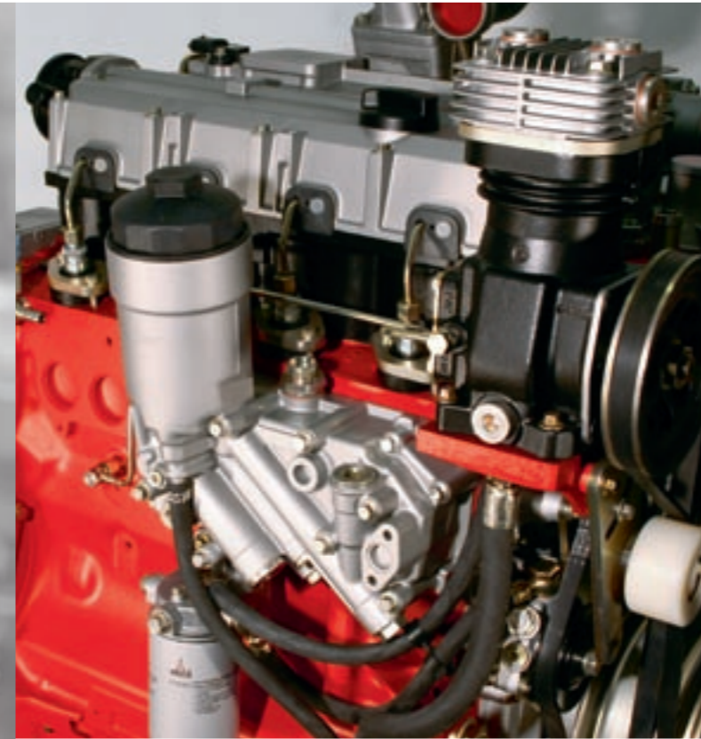
Des injecteurs à 6 trous assurent la combustion optimale du carburant.
