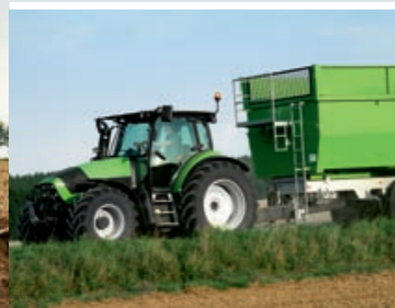
Avantages de l'ASM lors de transports sur route : Vitesse supérieure à 15 km/h = pont AV désactivé. Vitesse inférieure à 14 km/h = traction avant activée.
