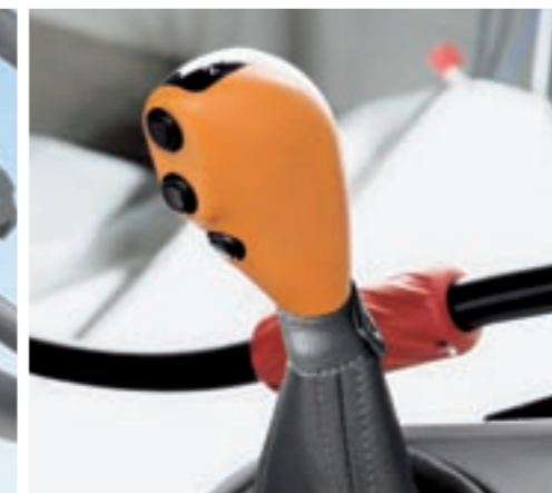
Passage des vitesses grâce à la commande par câble Bowden et à l'embrayage électrohydraulique.
