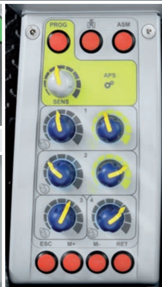
Le débit et la durée d'actionnement des distributeurs auxiliaires se règlent avec des boutons tournant sur la console de commande.
